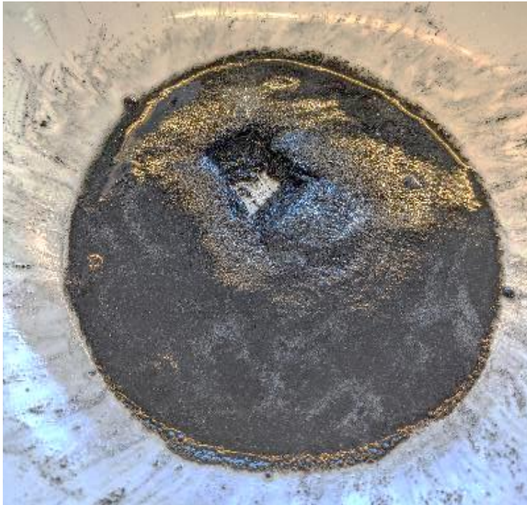
Figure 13 – TP70 montrant un comportement thixotrope après vibration
